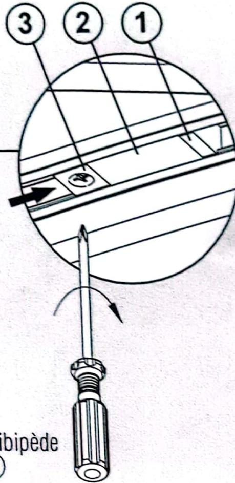
Introduire dans le rail suivant la flèche, les pièces composant le module amortisseur successivement par la plaquette ① puis le parallélibipède en caoutchouc ② et enfin le support avec la vis ③
