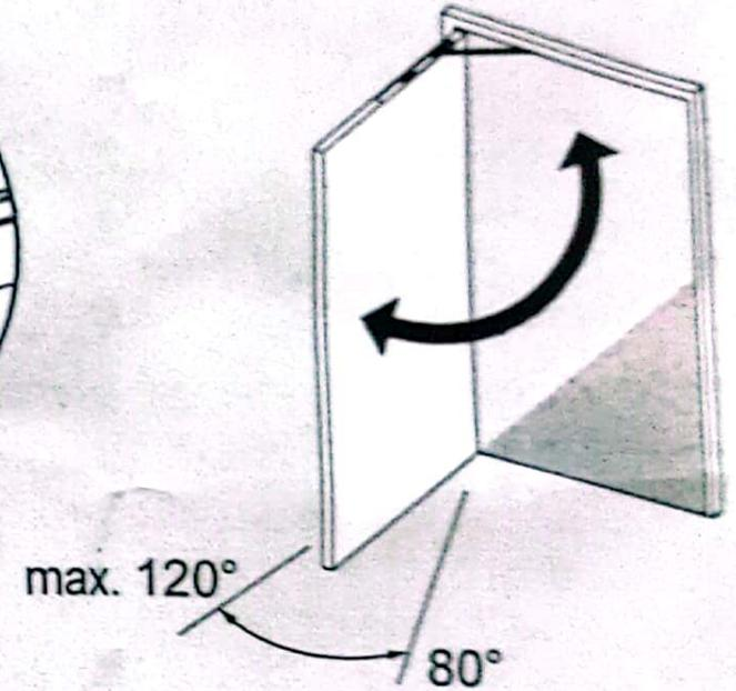
Ouvrir la porte jusqu'à l'angle désiré (entre 80° et 120°) et bloquer le support ③ en serrant la vis.
