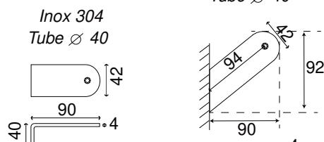
Fixation traversante par tige filetée, écrous et rondelles inox
