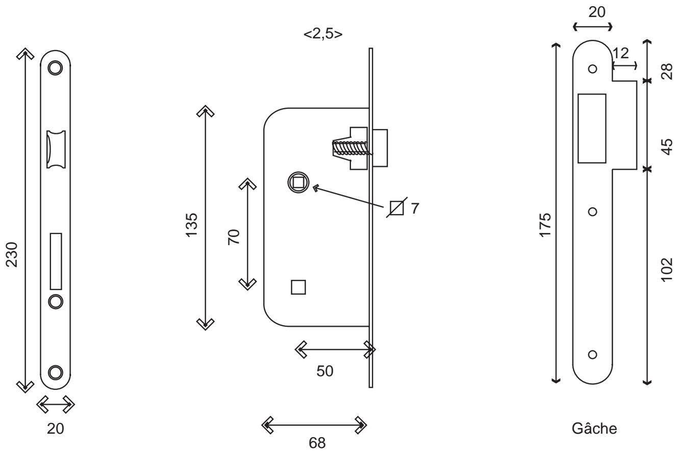
**Serrure parfaitement adaptée aux béquilles sur rosaces dans le cas des portes à recouvrement**
